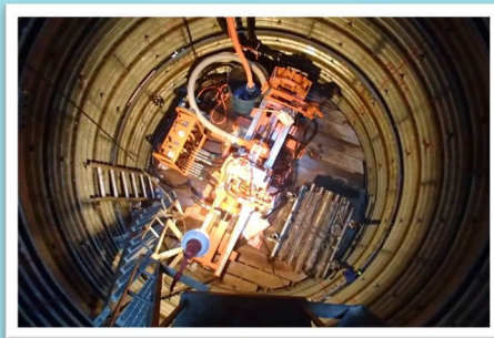
全油圧駆動 二重管式穿孔機K1-B
