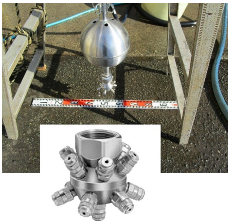
図-1 水井戸洗浄の大型ノズル
