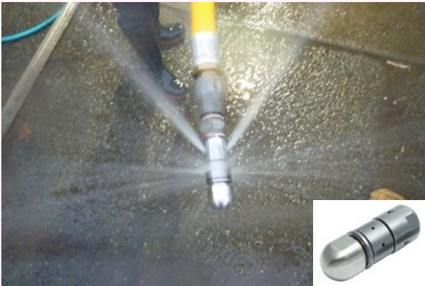
図-3 回転式パイプ洗浄用小型ノズル
