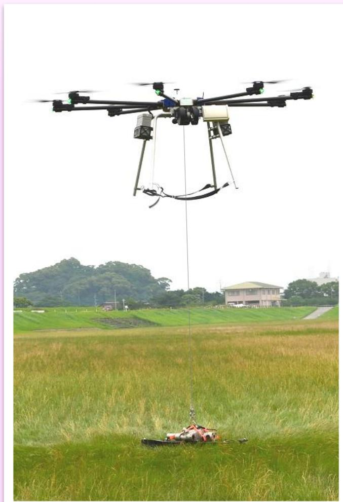
荷の吊り下ろしでは、荷が地面に着いた瞬間に自動でワイヤーを切り離します。
