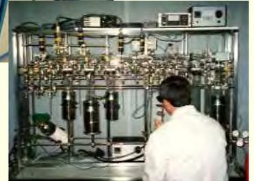
AMS年代測定用試料処理装置
