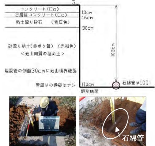
図-3 ローム質粘土での試掘例
